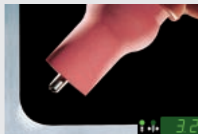
Průměr kaloty: 3,2 mm Základní materiál: AlMg3 Tloušťka plechu: 5 mm Svařovací proud: 185 A Svařovací napětí: 15,6 V Vývážení AC: 0
